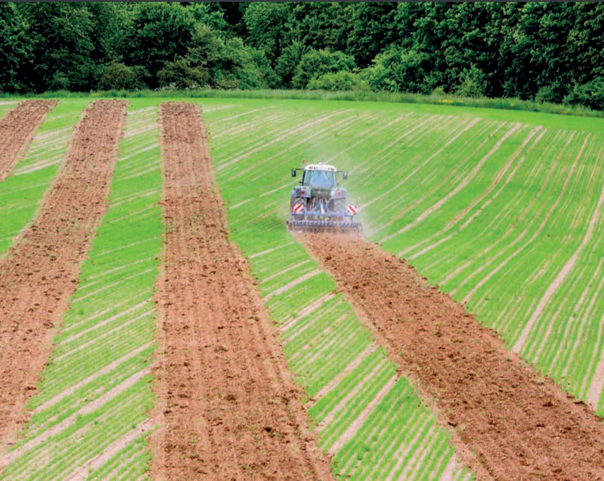
Наряду с TRACK-Leader TOP система руления состоит из дополнительного управляющего компьютера, датчиков и приемника GPS (D-GPS или RTK), который используется согласно требованиям точности. Автоматическое руление разгружает водителя, повышается производительность на единицу площади и снижается расход дизельного топлива. Наряду с гидравлическим рулением, являющимся самым точным, для дополнительного оснащения предлагается электромотор с фрикционным кольцом на рулевом колесе.
